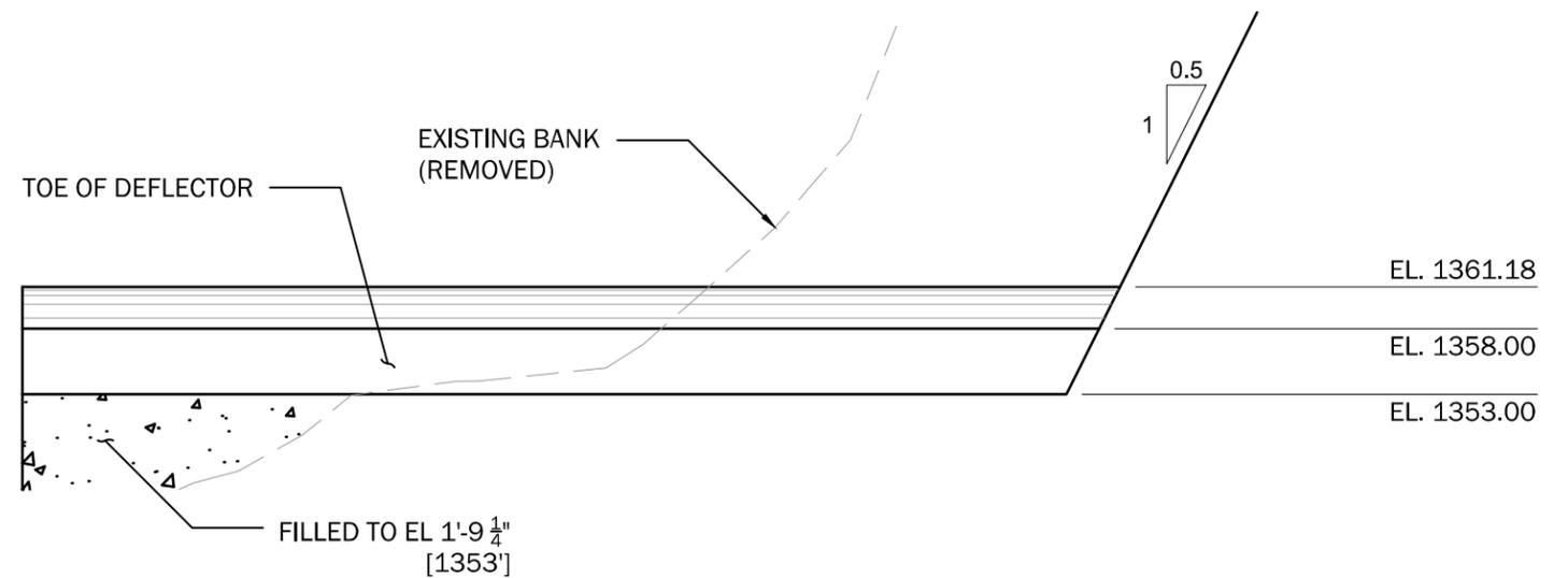
**2 TYPICAL ELEVATION - SPILL BAY 7 & 8 DEFLECTORS**
